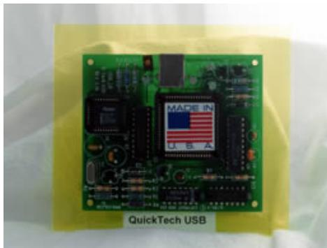
**QuickTech USB** je projektovan da brzo i precizno utvrdite gde je problem kada USB port otkaže poslušnost. Ovaj testni uređaj je izrađen prema USB specifikaciji 1.1 i samostalan je u pojedinačnom testiranju svih postojećih USB portova. QuickTech USB, takođe, može da se koristi sa PHD PCI dijagnostičkom karticom i QuickTech Pro softverom.
