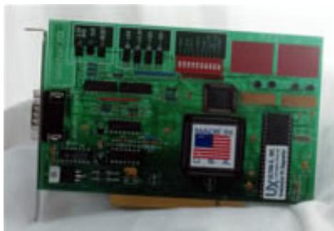
**QuickPost PCI Serial** poseduje iste funkcije kao i QuickPOST PCI 3.3, ali može istovremeno da prikaže podatke sa portova 80 i 81 na duplom 7-segmentnom displeju. Takođe, kartica može da prosledi podatke kroz seriski port na ploči. Odličan alat za razvoj, prikupljanje podataka i otklanjanje grešaka.
