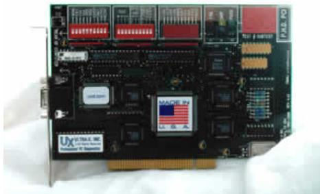
**P.H.D. PCI** je prva i za sada jedina tzv. Plug-in PCI test kartica, koja obavlja testiranja na nivou komponenti širokog dijapazona sistema, od 486 mašina pa sve do Intel Pentium 4 sistema.
