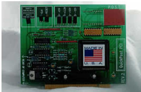
**QuickPost PCI 3.3** koristi najsavremeniju tehniku dekodiranja, čime uspešno prati BIOS standarde. Potpuno podržava kompletne PCI specifikacije usled čega u priličnoj meri smanjuje ili eliminiše guesswork involved\*\* kod neispravnih sistema koji ne uspevaju da se pokrenu (startuju). To je alatka koju mora posedovati svaki serviser.
