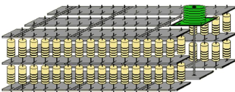
Dva bloka spojena u seriju imaju otpornost približno 150W. I na kraju tri dvostruka bloka spojena paralelno čine dummy load impedanse oko 50W. Ukupna impedansa dummy load-a se može izmeriti multimetrom, a vrednost se može korigovati
